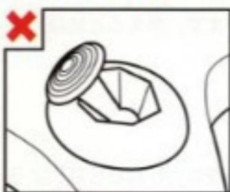
この時に、3Dスティックが傾いている場合(左上の図)、傾いた状態が「ニュートラルポジション」と設定されます。このようにニュートラルポジションの位置がズれた状態では、3Dスティックが正常に操作できなくなります。
